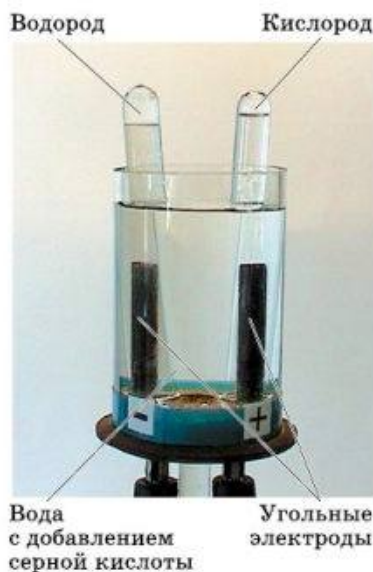
Рис. 114. Электролиз воды в лабораторных условиях
