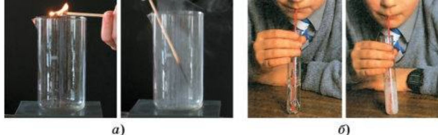
Рис. 63. Способы распознавания углекислого газа: а — тлеющей лучинкой; б — известковой водой
