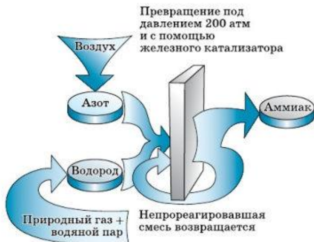
Рис. 107. Схема промышленного получения аммиака
