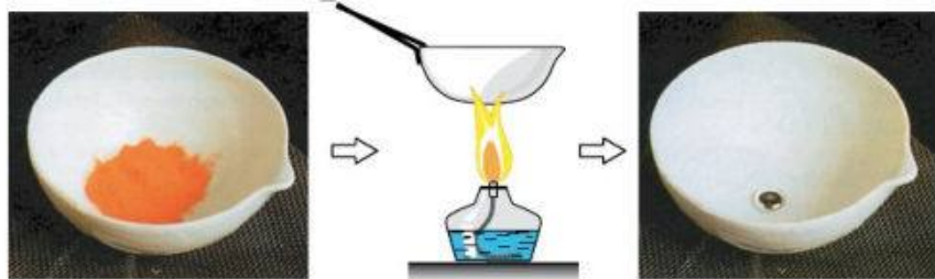
Рис. 94. Получение кислорода разложением оксида ртути
