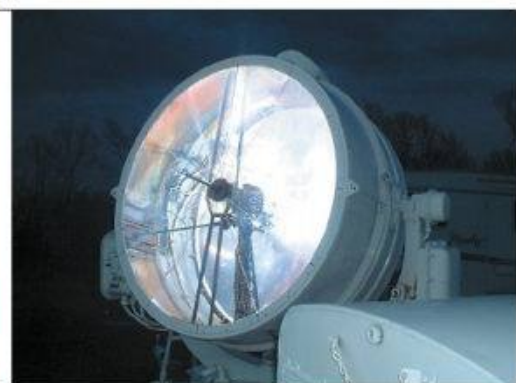
Рис. 20. Отражающая способность зеркал (а) и прожекторов (б) обусловлена блеском применяемых при их изготовлении металлов
