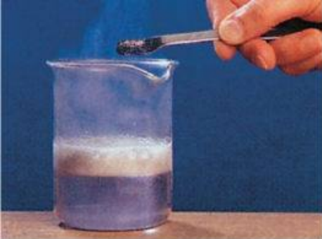
Рис. 95. Разложение пероксида водорода при внесении катализатора — оксида марганца (IV)
