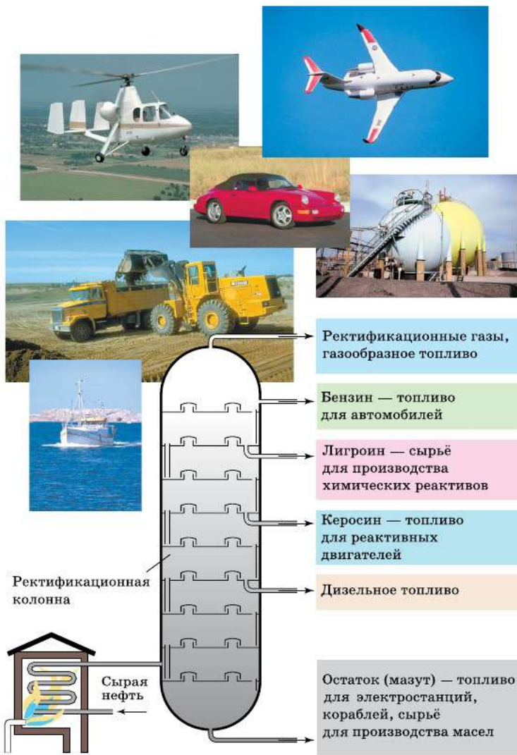
Рис. 28. Схема установки (ректификационной колонны) для непрерывной перегонки нефти и области применения нефтепродуктов
