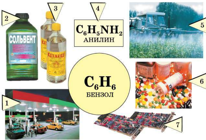
Рис. 26. Применение бензола: 1 — добавка к бензину; 2 — производство растворителей; 3—7 — производство органических соединений (аcetона 3, анилина 4, пестицидов 5, лекарственных средств 6, фенолоформальдегидных пластмасс 7)
