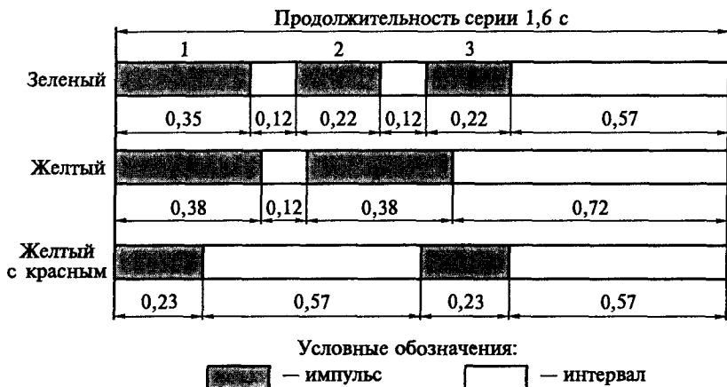
Рис. 9.2. Схема кодов локомотивной сигнализации
