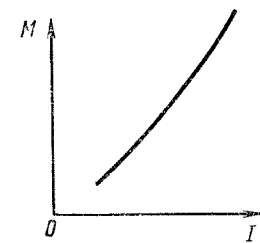
Рис. 62. Зависимость вращающего момента от тока двигателя последовательного возбуждения
