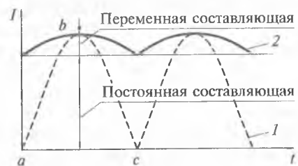
Рис. 13.4. Кривые выпрямленного тока без сглаживающего реактора (1) и при его наличии (2):
