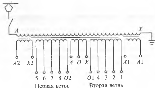
Рис. 11.1. Схема регулирования напряжения на низшей стороне тягового трансформатора ОЦР-5000/25
