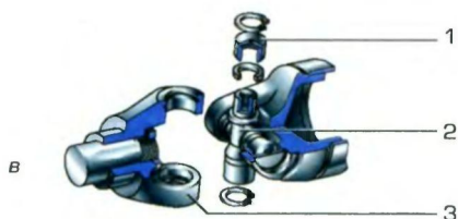
Рис. 33. Карданная передача: а — общий вид карданной передачи автомобиля классической компоновки; б — общий вид кардана [1 — карданный шарнир, 2 — труба кардана]; в — карданный шарнир [1 — подшипник, 2 — крестовина, 3 — вилка].
