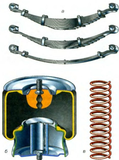
Рис. 42. Виды упругих элементов подвесок: а – рессоры; б – пневмобаллон; в – пружина.
