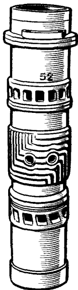
Рис 37 Втулка цилиндра дизеля типа Д100 повышенной прочности с поперечным расположением ребер в зоне отверстий под адаптеры
