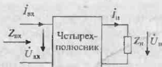
Рис. 12.1. Схема активного преобразователя сопротивлений и проводимостей
