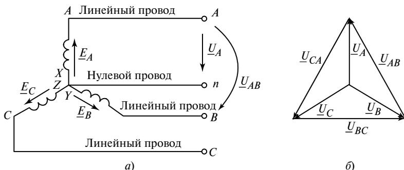
**Рис. 12.4.** Соединение обмоток источника звездой:
