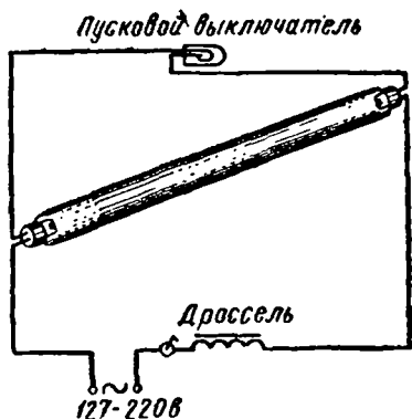
Фиг. 68. Схема включения люминесцентной лампы
