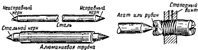
Фиг. 324. Конструкция осей и подпятника электроизмерительного прибора
