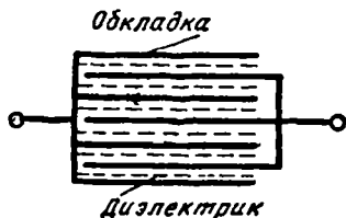
Фиг. 14. Схема устройства конденсатора постоянной емкости
