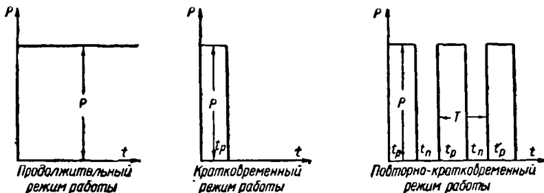
Фиг. 383. Графики работы двигателей для различных режимов работ
