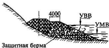
Рис. 5.5. Поперечный профиль насыпи из скального грунта, отсыпанной в русле реки:
