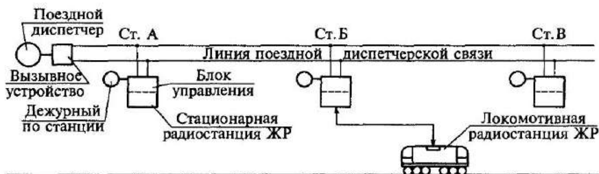
Рис. 19.1. Схема двусторонней поездной радиосвязи:
