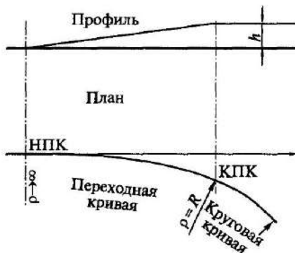
Рис. 7.3. Профиль и план переходной кривой:
