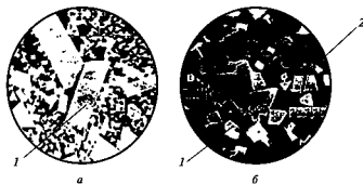
Рис. 8.3. Микроструктуры вольфрамовых сплавов: а — ВК15; б — Т15К6; 1 — карбиды вольфрама; 2 — твердый раствор (Ti, W)C
