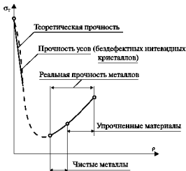
Рис. 1.7. Зависимость предела текучести от плотности дислокаций: \sigma_t — предел текучести; \rho — плотность дислокаций
