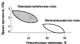
Рис. 11.6. Соотношение между прочностью и пластичностью стали
