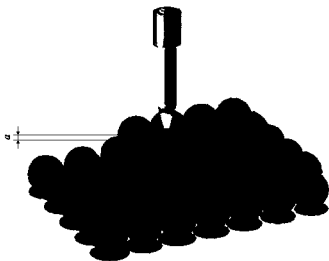
Рис. 11.3. Игла сканирующего туннельного микроскопа, находящаяся на постоянном расстоянии ( a ) над слоями атомов исследуемой поверхности
