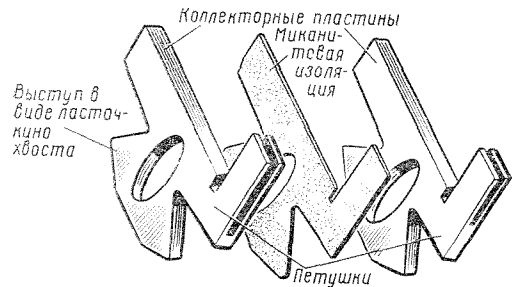
Рис. 171. Детали коллектора тягового электродвигателя
