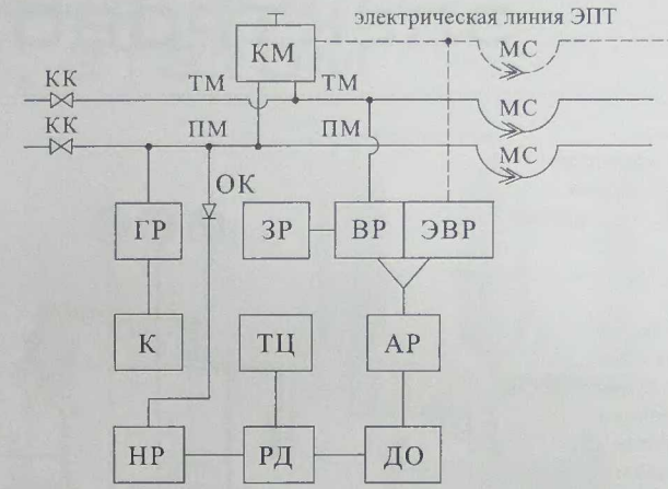
Рис. 4.4. Структурная схема тормозного оборудования электропоездов
